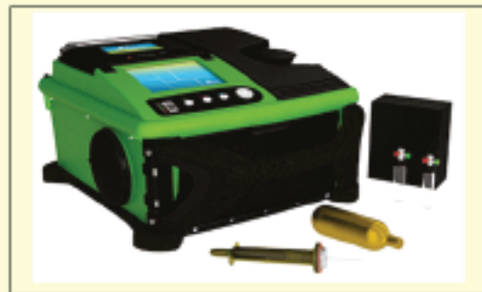
Hình 1: Thiết bị Torion T-9 GC-TMS và ống tiêm lấy mẫu SPME
